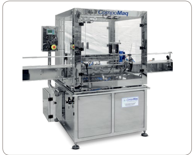
Rinser Linear Automático para Galões de 5 e 10 Litros Enjuagador Linear Automático para Galones de 5 y 10 Litros
